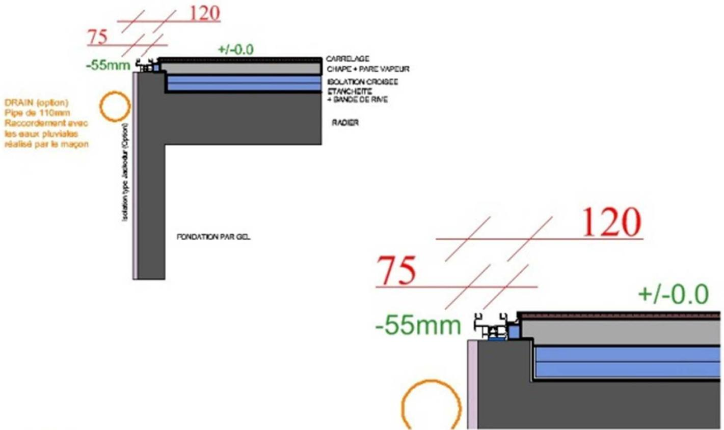
Détail de base pour maçonnerie
